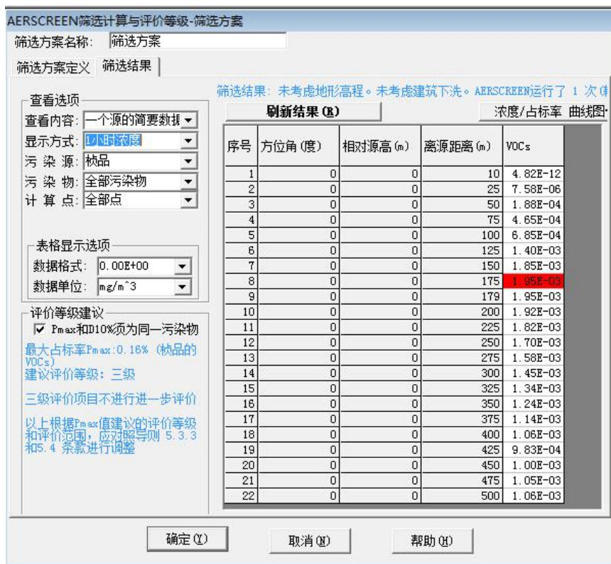
图-2项目 1#有组织废气1h排放浓度
