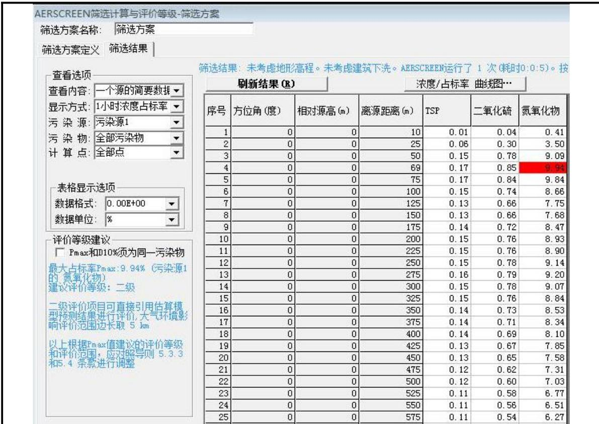
图4 项目天然气燃烧废气排气筒占标率估算结果截图
