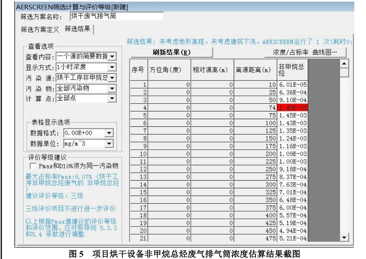
图5 项目烘干设备非甲烷总烃废气排气筒浓度估算结果截图
