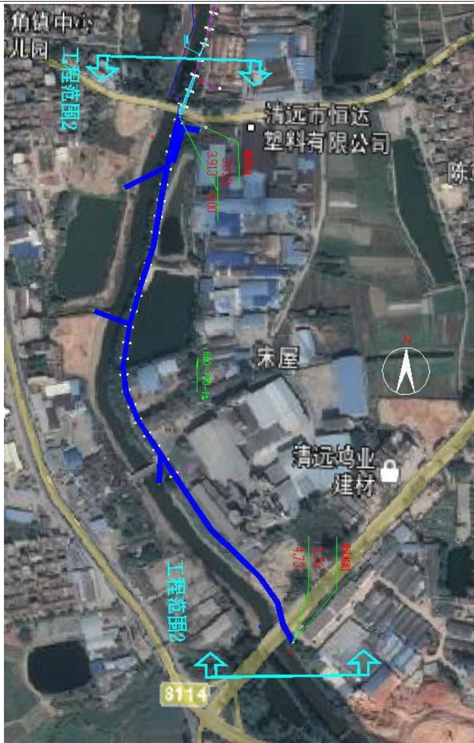
图1-3 河段二管线布置情况
